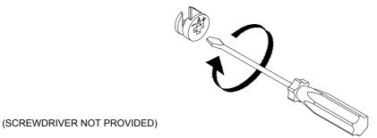
USE A FLAT HEAD SCREWDRIVER TO TIGHTEN THE CAM NUTS. A QUARTER TURN CLOCKWISE IS ALL THAT IS NEEDED.
