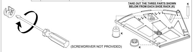
USE A FLAT HEAD SCREWDRIVER TO TIGHTEN THE CAM NUTS. A QUARTER TURN CLOCKWISE IS ALL THAT IS NEEDED.
